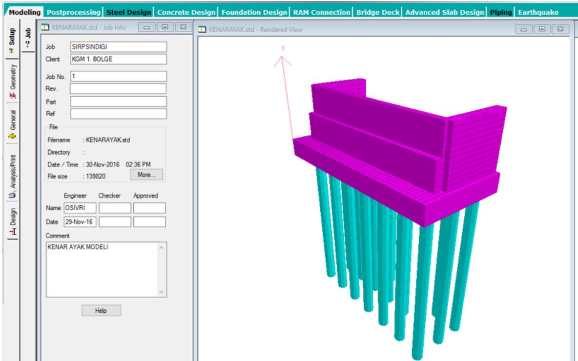
*Picture 23 Edirne Sirpsındığı Bridge abutment static modeling*
