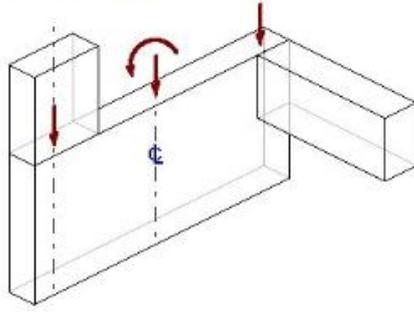
STA4-CAD Perde ve kolonlarda eksenal yük kaçıklıklarını opsiyonel olarak dikkate alır. Geometrik akslar, elemanların bilgi tanımı içindir. Statik hesaplarda, elemanların ağırlık merkezlerini dikkate alarak gerçek eksenlerle çalışır. Perdeler zayıf yönde sızlanan kirişlerin, düşey plak gibi davranan perdedeki lokal eğilme deformasyonunu sonlu elemanlara eşdeğer yöntemle elastik ankastrelik değerlerine göre opsiyonel çözüm yapabilir.
